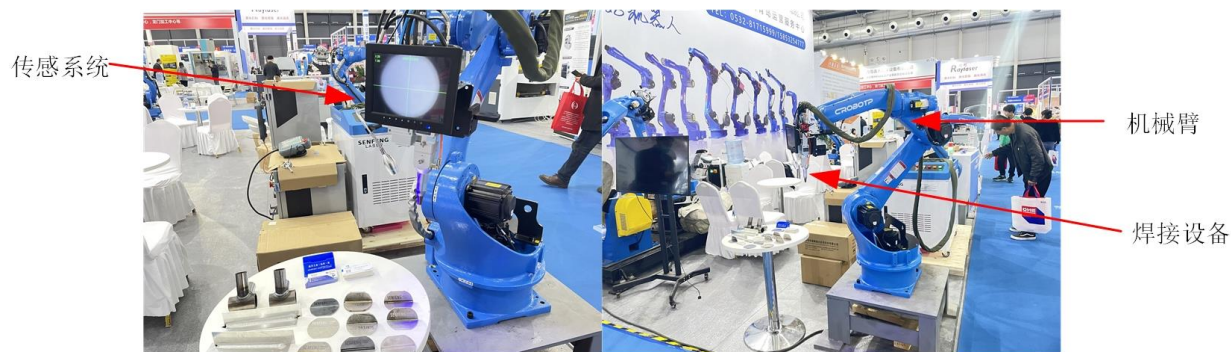
图 3 机械臂焊接技术
